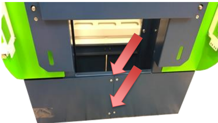
Obrázek 5: Umístění šroubů spodního krytu
